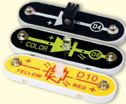
Bílá, barevná a červená/žlutá LED dioda (D4, D8 a D10)
