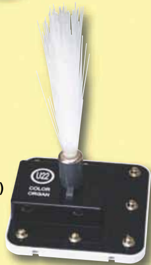
Rozvětvený optický kabel (LED doplněk) zapojen do U22
